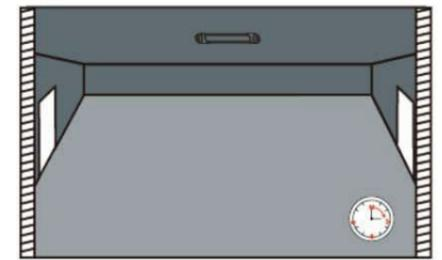
3. Nach Ablauf der Nachlaufzeit schaltet der Sensor das Licht aus, wenn keine Bewegung mehr erkannt wird
